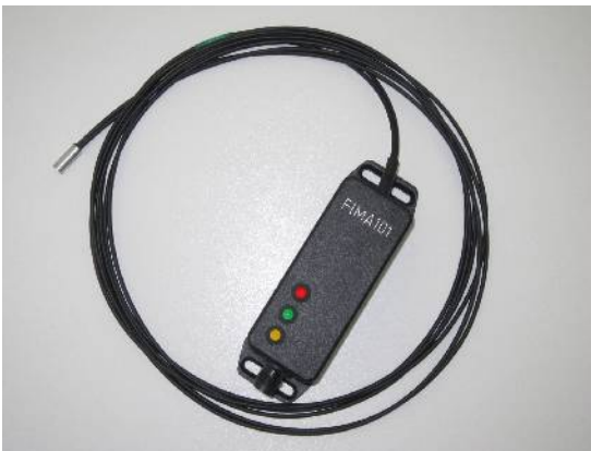
Abb.: Erfolgreich bei arteos durchgeführtes DFSS-Projekt „optischer Fasersensor mit einer Auflösung bis 10 nm“
