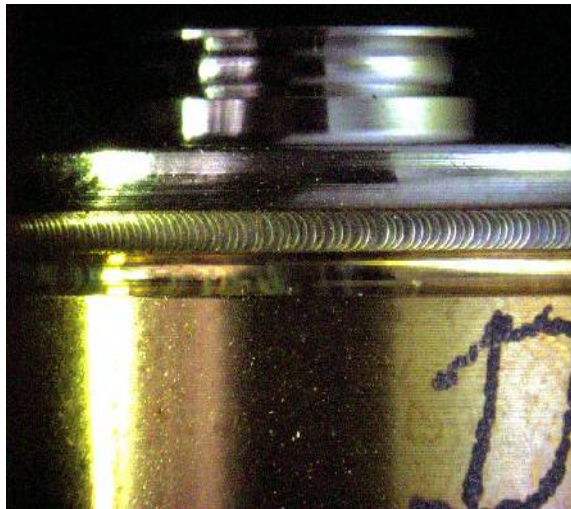
Nr. 10: Edelstahlgehäuse mit Laser geschweißt; Wandstärke = 1,2 mm
