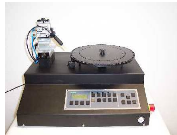
Nr. 13: Randlackiergerät für optische Mikrolinsen
